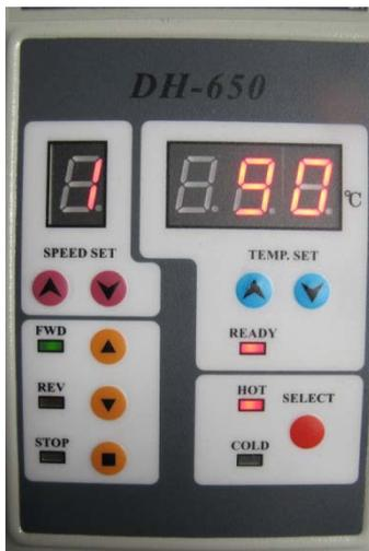
Für empfindliche Materialien, wie z.B. PE Folie, die Temperatur auf ca. 80° - 90° C einstellen und eine langsame Geschwindigkeit (Stufe 1-2 auf dem DH-650 Modell) wählen. Für dickere Substrate mit rauen Oberflächen, wie z.B. Karton oder unempfindliche Materialien wie Blech, kann ohne weiteres auch eine höhere Transfertemperatur gewählt werden (bis ca. 170° C). Vergewissern Sie sich, dass sich die Andruckwalzen in der 'Close' Position befinden.
