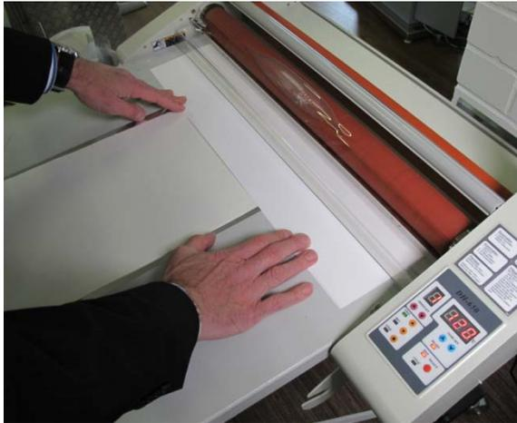
Halten Sie den Transferfilm und den Bedruckstoff auf beiden Seiten zusammen und führen Sie sie in das Gerät ein, bis die Andruckwalzen das Material erfasst haben und transportieren. Nutzen Sie nach Möglichkeit nicht die volle Breite des Gerätes aus, da ansonsten das Material an den Kanten beschädigt werden könnte, wenn es nicht absolute gerade eingeführt wurde.
